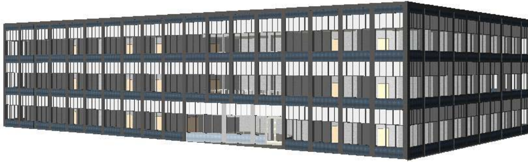
Abb. 9. Zur Erstellung einer perspektivischen Ansicht muss in Architectural Desktop lediglich ein Kamera-Symbol eingefügt werden.
