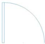
Abb. 1. Zur Definition eines Türobjekts werden in AutoCAD einfache Linien und Bögen verwendet.
